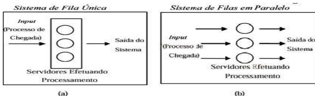
Figura 2: (a) Sistema de fila única (modelo M/M/m) e (b) sistema de filas paralelas e independentes (modelo M/M/1)
