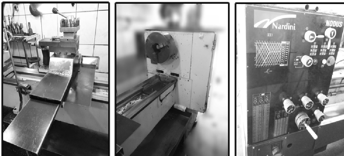
FIGURA 3: Carrinho principal FIGURA 4: Cabeçote principal FIGURA 5: Painel de controle completo e Placa giratória
