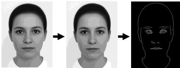
Figura 5: Imagem Original Figura 6: Filtro da Mediana Figura 7: Detector de Sobel
