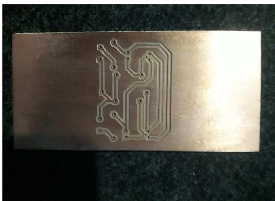
**Figura 1 - Placa de Fenolite usinada com a máquina CNC**
