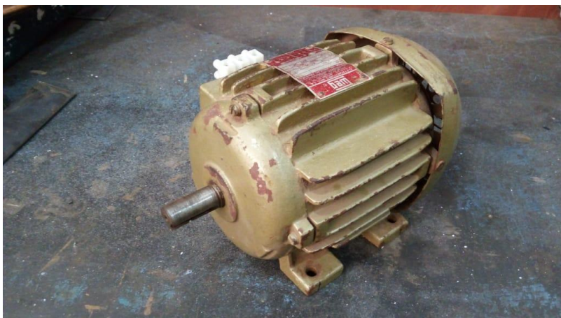
Figura 8. Motor de indução trifásico.
