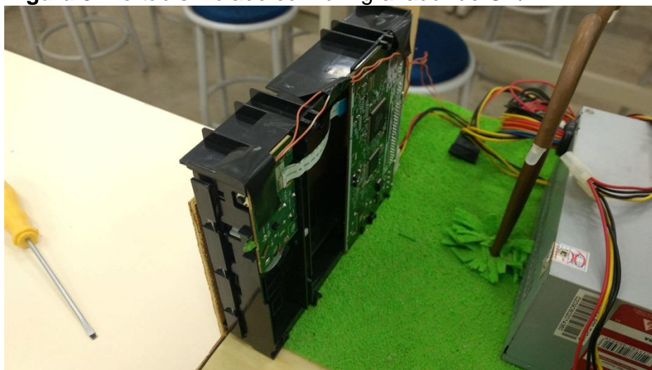
Figura 8. Portão simulado com um gravador de CD/DVD
