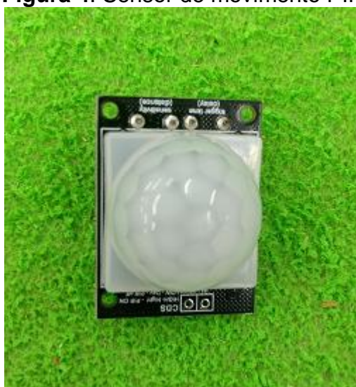
Figura 4. Sensor de movimento PIR
