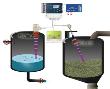
Figura 4. Modelo de funcionamento de Sensor Ultrassônico
