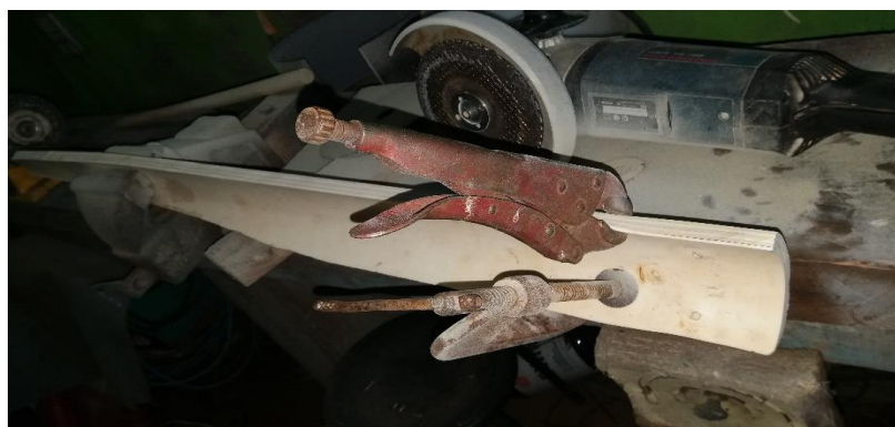
Figura 7: Hélices do aerogerador
