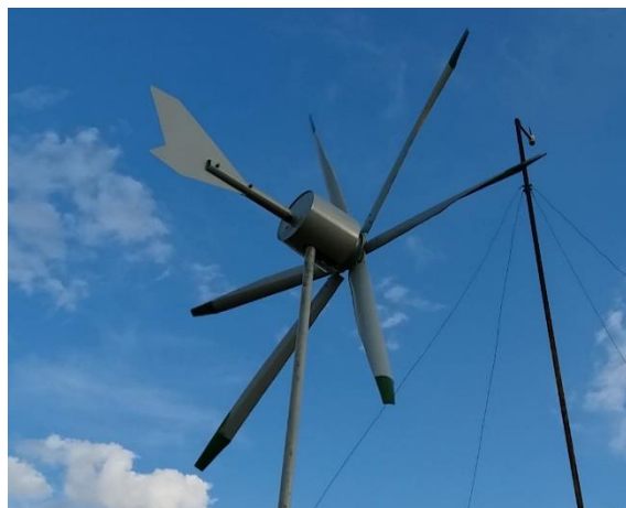
Figura 19: Aerogerador feito de sucata
