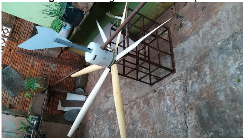
Figura 10: Aerogerador em construção
