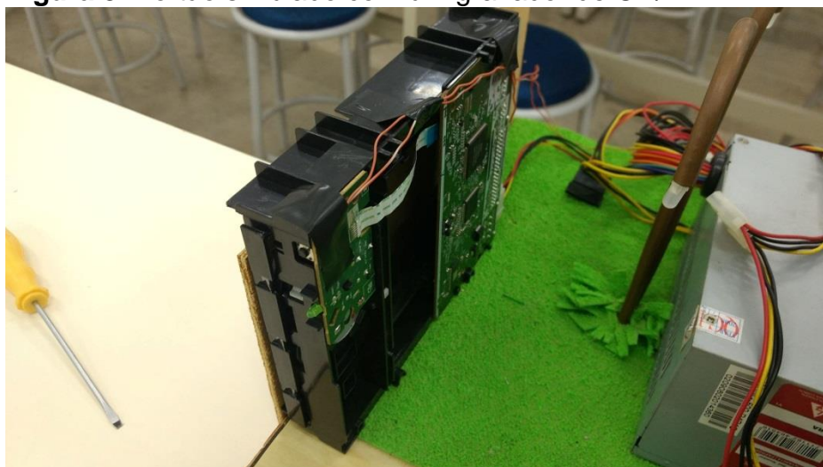
Figura 8. Portão simulado com um gravador de CD/DVD
