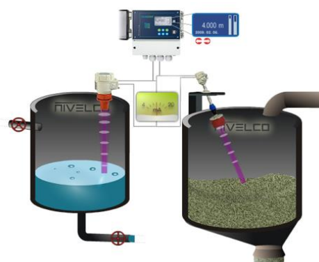
Figura 4: Modelo de funcionamento de Sensor Ultrassônico
